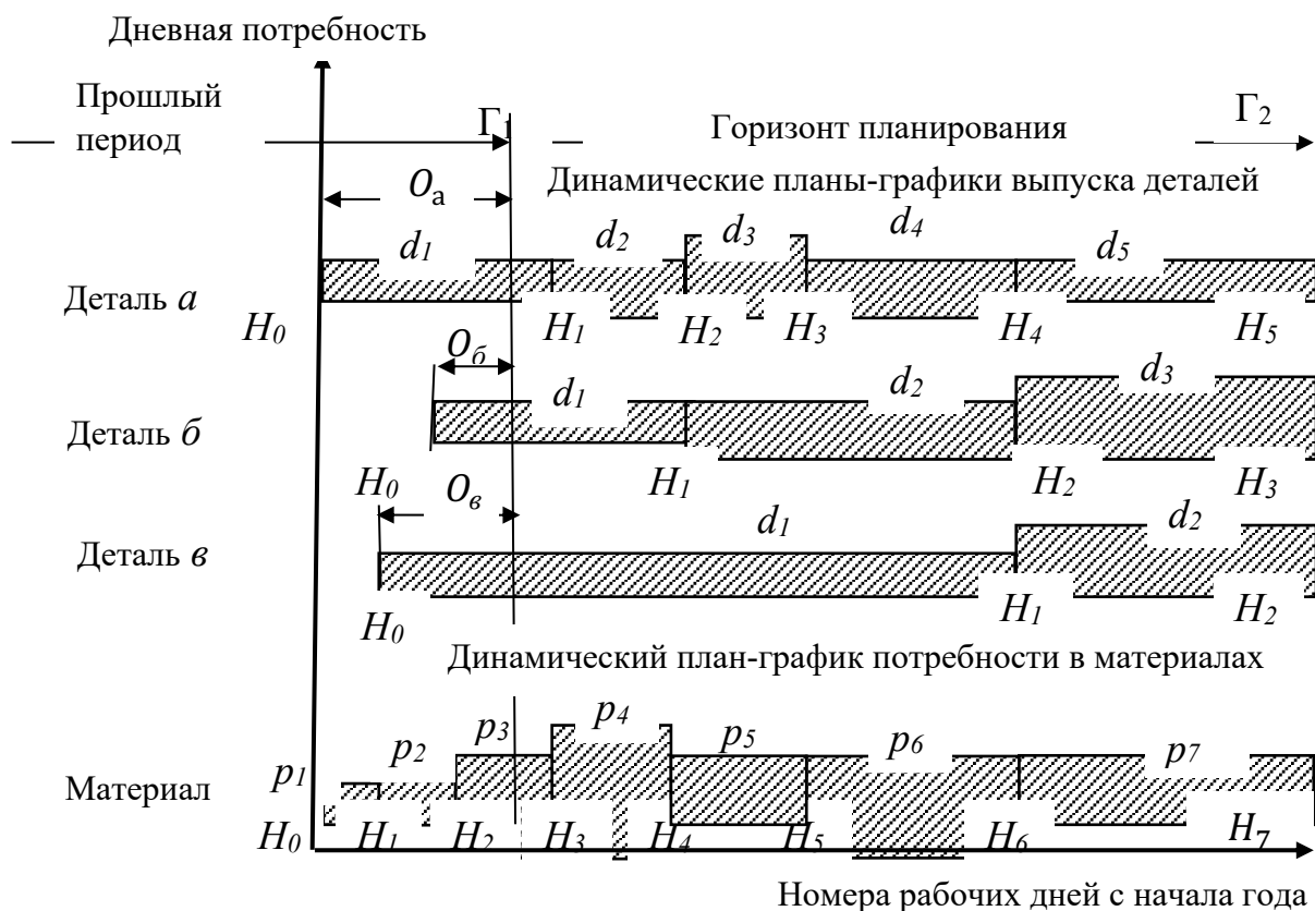
Рис. 2. Схема формирования динамического плана-графика потребности в материалах на основе динамических планов-графиков выпуска деталей
