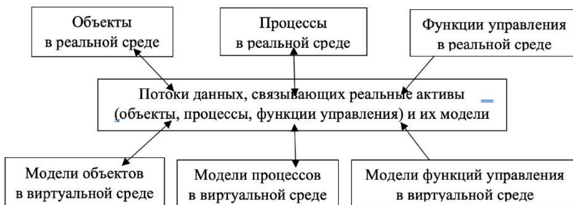
Рис. 1. Схема создания единой цифровой модели машиностроительного предприятия Fig. 1. Scheme for the creation of a single digital model of a machine-building enterprise
