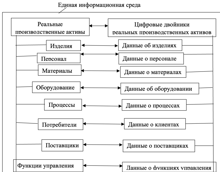
Рис. 2. Принципиальная схема создания цифрового двойника на машиностроительном предприятии
