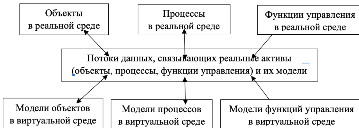
Рис. 1. Схема создания единой цифровой модели машиностроительного предприятия
