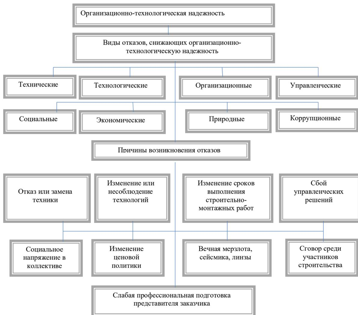
Рис. 2. Отказы, снижающие организационно–технологическую надежность и причины их вызывающие
