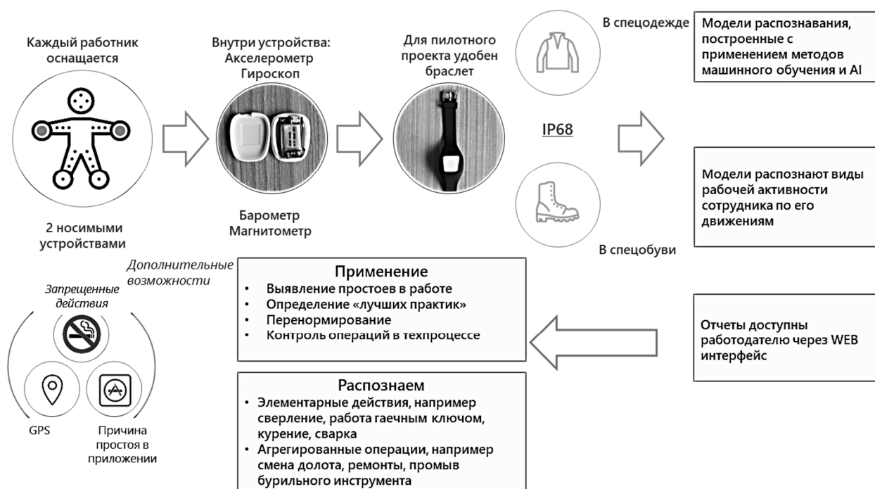
Рис. 1. Система мониторинга активности работников с помощью носимых гаджетов
