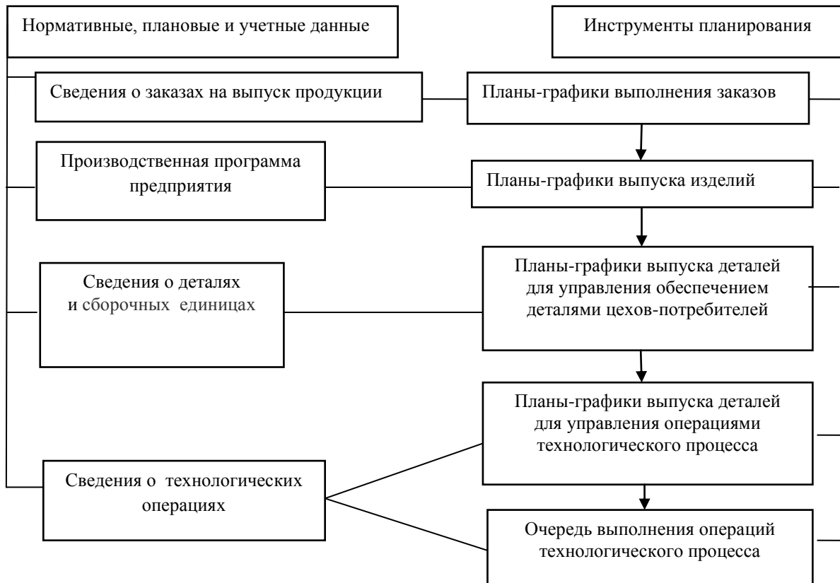
Рис. 1. Принципиальная схема оперативного планирования цифрового производства Fig. 1. Schematic diagram of the operational planning of digital production
