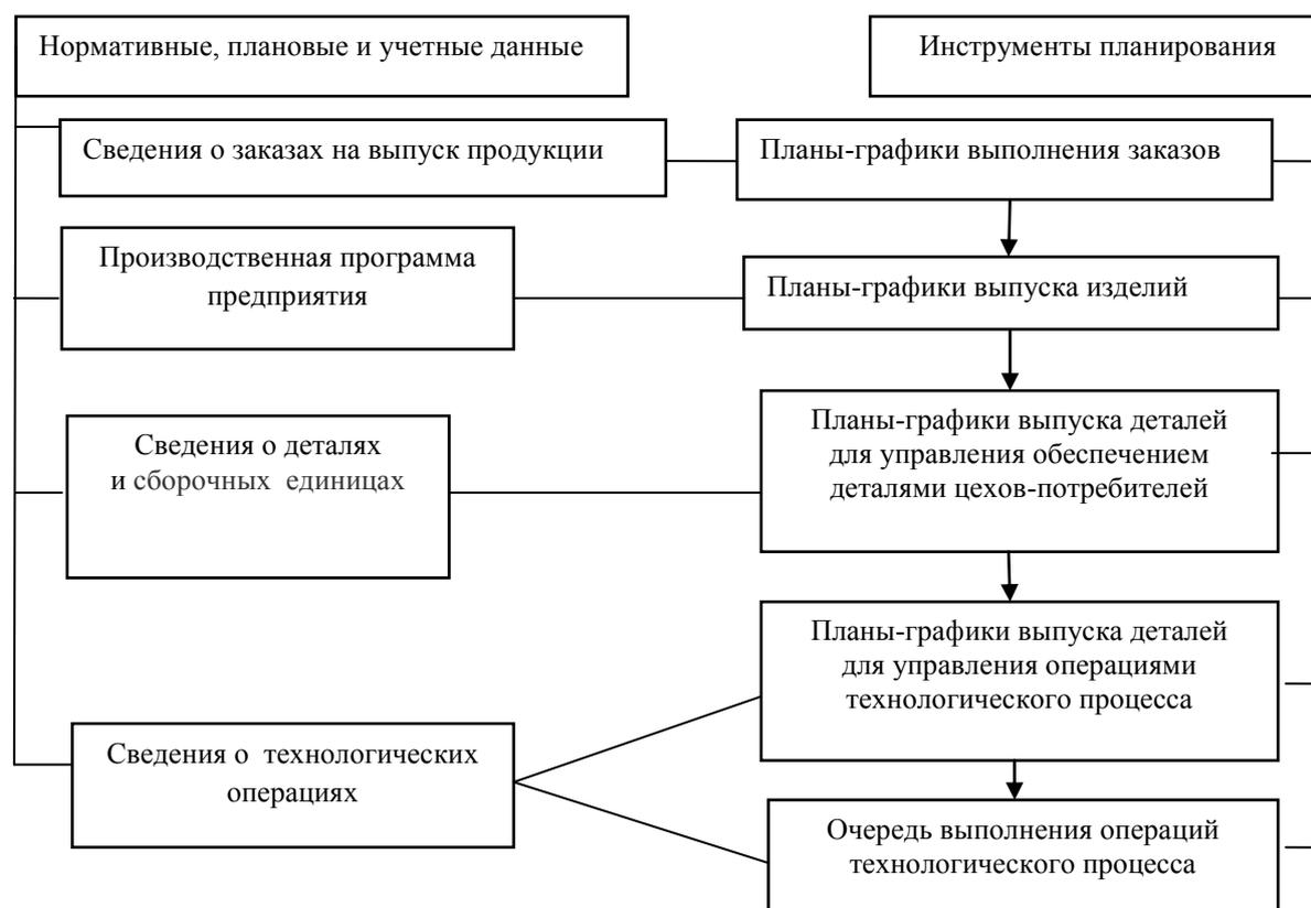
Рис. 1. Принципиальная схема оперативного планирования цифрового производства
