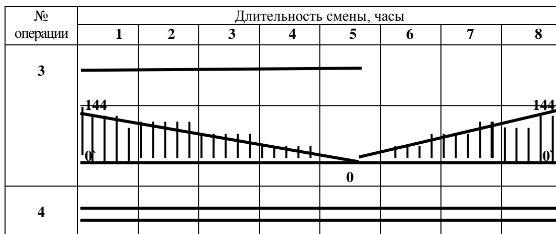
Рис. 4. Окончательный этап построения графика изменения величины межоперационных оборотных заделов между двумя смежными операциями
