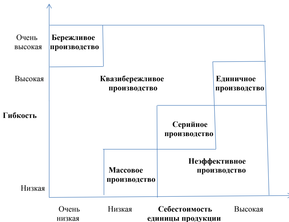
Рис. 1. Характеристика видов производства по гибкости и себестоимости изготовления продукции
